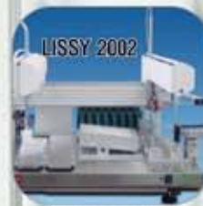
Robot de pipetage LISSY 2002 à deux bras
